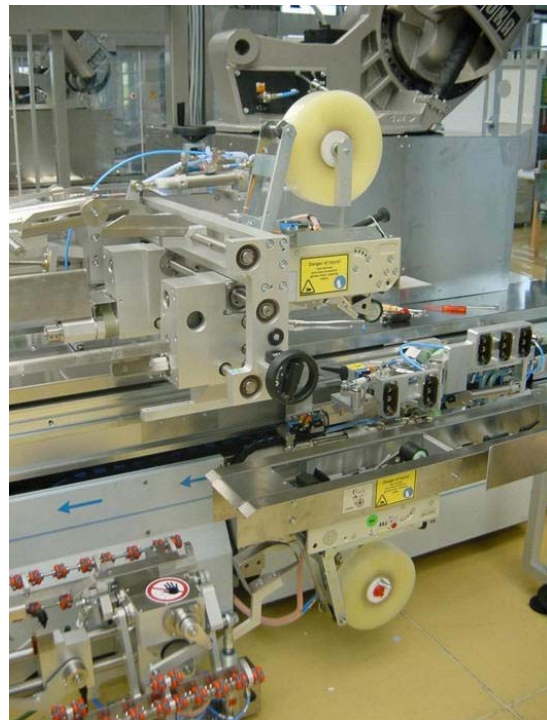
Verklebeeinheit mit Selbstklebeband oben und unten überlappend
