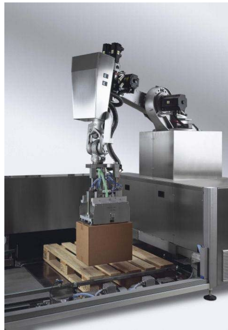
6- Achsiger Gelenkarm Roboter Kuka KR 15 für die Beladung der Sammelkartons und die Palettierung nach dem Etikettieren der Sammelkartons
