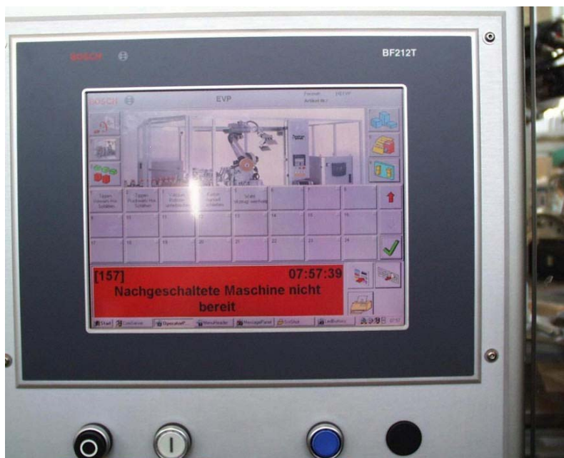
Bedientableau mit extra grosser Grafikfähiger Anzeige in Touch- Screen Ausführung
