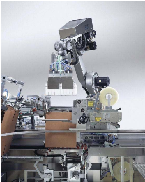
6- Achsiger Gelenkarm Roboter Kuka KR 15 für die Beladung der Sammelkartons und die Palettierung nach dem Etikettieren der Sammelkartons
